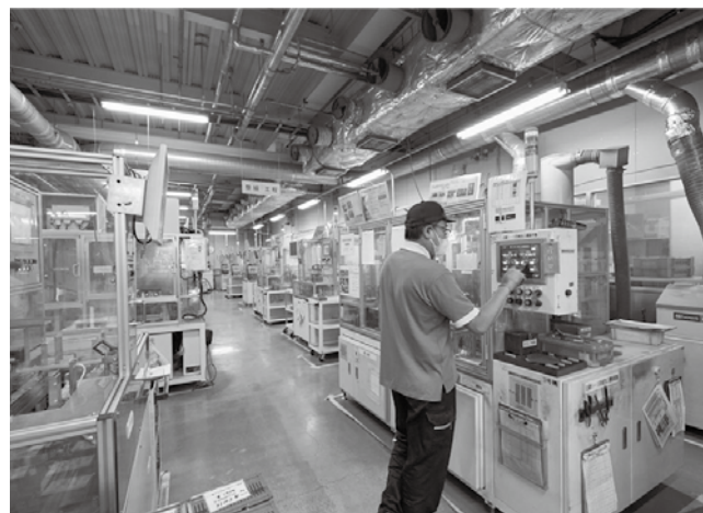
▲ 製品の検査は熟練の検査員による目視や、写真のような専用機器を使った画像検査等、丁寧に行う。
