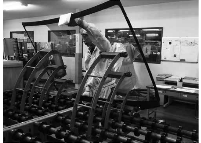
▲ 印刷工程へのガラス投入作業
