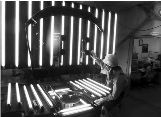
▲ 自動車ガラス製品の最終検査
